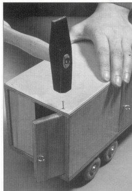
Figuur 4: Plaatsen van de scharnierpennen
