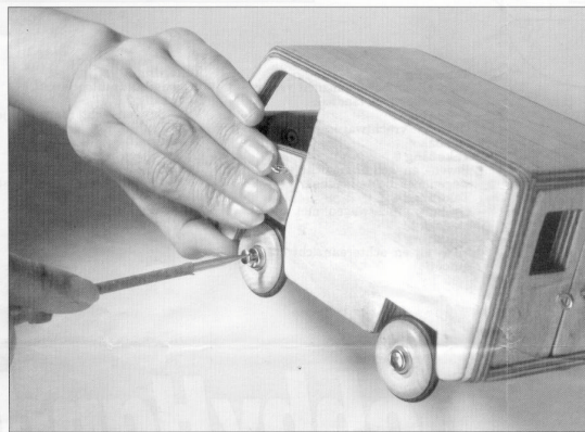
Figuur 6: Montage van de wielen op de bestelbus
