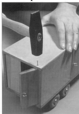
Figuur 5: Plaatsen van de scharnierpennen, zoals hier bij een vrachtwagen
